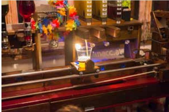
Unter den Cocktail-Robotern ist die mysteriöse „Melmacc“ eine der schnellsten. Mit dem Smartphone kann sie gesteuert werden und schafft an einem Abend bis zu 550 Cocktails. Ein Cocktail in der Minute läuft über das Fließband dieses Roboters, der vor etlichen Jahren in einer Garage entstand. Seitdem arbeitet das Team an der Vollautomatisierung.
